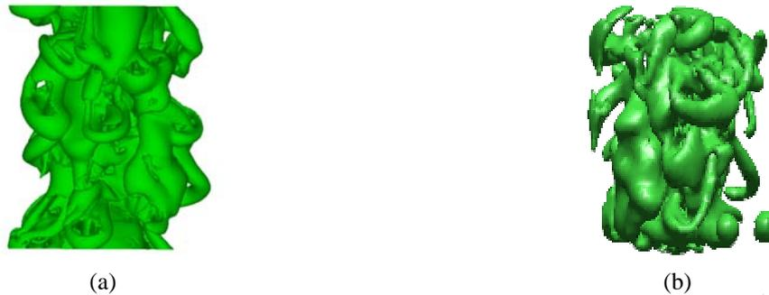
Figura 11. Visualizações da vorticidade no jato natural: (a) Isosuperfície de vorticidade= $1,3s^{-1}$  (presente trabalho), (b) visualização experimental via PIV (Sakakibara, 2004).
